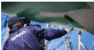
Auftragen von Antifouling auf Primer oder Haftgrund
