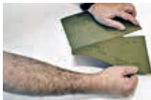
Schleifpapier dem Schleifblock anpassen
