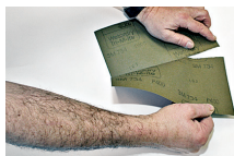
Schleifpapier dem Schleifblock anpassen
