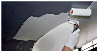
Antifouling auf Primer auftragen
