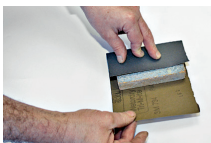
Schleifpapier um den Block legen
