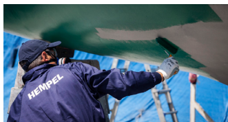
Auftragen von Antifouling auf Primer oder Haftgrund
