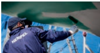
Apply antifouling over primer or tiecoat
