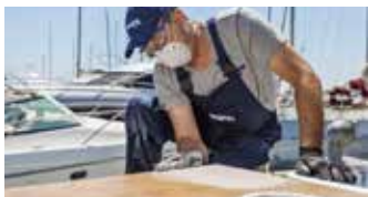
Lijado de la superficie
