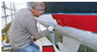
Aplicación en la línea de flotación
