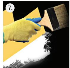
Aplique una capa de Hempel's Silic One sobre la zona dañada, sobre una superficie ligeramente superior a la zona tratada con Silic One Tiecoat. (aplicar una capa de Silic One a toda la superficie de la obra viva).
