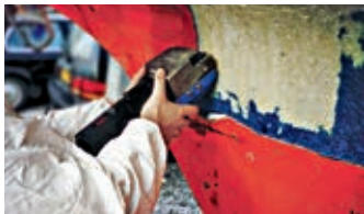
Pelando el gelcoat con una peladora (gelcoat peeler)
