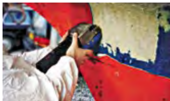
Borttagning av gelcoat
