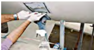
Våtskrapa för att ta bort gammal bottenfärg
