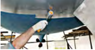
Applicera Hempel's High Protect II med rulle
