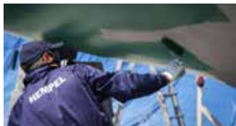
Nanesite antifauling povrh temelja ili izolacijskog premaza
