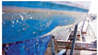
Blærer i og avskalling av maling
