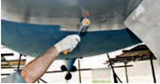
Påfør Hempel's High Protect II med malerull
