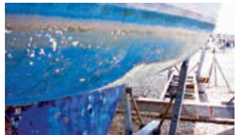
Blærer i og avskalling av maling
