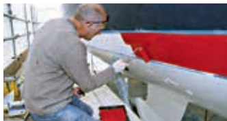
Påføring av vannlinjemaling
