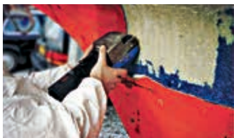
Fjerning av gelcoat med gelcoathøvel
