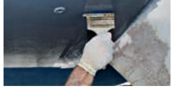
Jevn ut Hempel's High Protect II i motsatt retning med pensel
