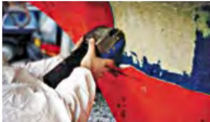
Fjerning av gelcoat med gelcoathøvel
