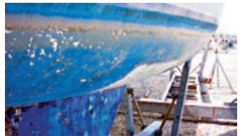
Blærer i og avskalling av maling
