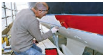
Påføring av vannlinjemaling
