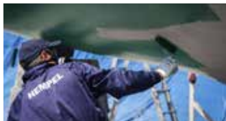
Antifouling opbrengen over primer of hechtverbeteraar
