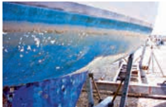
Verfblaasjes en omhooggetrokken verf
