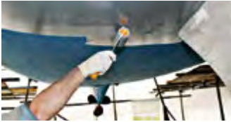
Applicera Hempel's High Protect II med rulle
