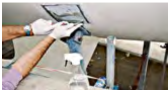
Våtskrapa för att ta bort gammal bottenfärg
