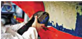
Borttagning av gelcoat
