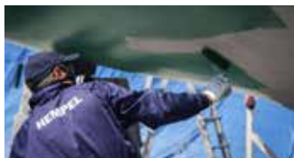
Applicera bottenfärg över grundfärg eller häftgrund
